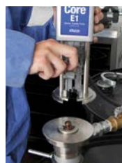
3. Far scorrere il motore elettrico da rimuovere
